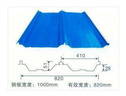
施工工序及施工要点: 1. 屋面清理→20厚1: 3水泥砂浆铺抹→配套隔气层粘贴→120厚苯板铺贴→C7.5炉渣混凝土找坡层浇筑→木结构→彩钢瓦→外架子安装及外檐装修→拆除外架子。2. 作业面准备: 保温层施工: 将屋面基层清理平净、基层清理到实处防水层施工: 找平层水泥画浆层平态、密实、无空鼓、起、基层干燥,含水率小于9%,第二层水卷材施工前,应该检查靠前层防水的成分保护工作,避免因其它工序施工造成防水层破坏示经发现,如有破坏,修复后施工下一防水。在砂浆凝固前,用铁抹子压2遍,找平压实,找平层要进行养护,养护前≥7天,待基层干燥后进行卷材防水施工。铝制彩钢瓦厂家质量要求: 节点做法应符合设计要求。
