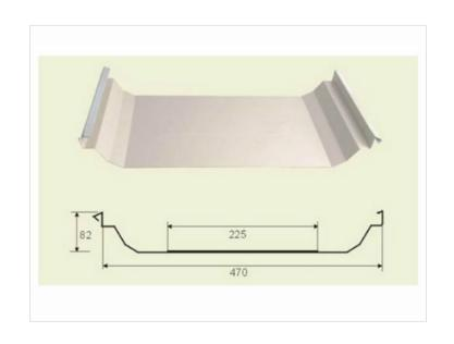
彩钢瓦屋面安装:屋面安装:1、两个脚手架用钢管架设。每个脚手架配有四个轮子,便于推动。2、先安屋面内层板,根据技术要求,每个波峰用30mm长的专门自攻螺钉固定,螺钉帽颜色与彩板颜色相同。3、铺上保温棉,保温棉接头处用专门胶带封接头。4、安装固定件,把固定件用自攻螺钉固定在每根檩条上。5、将一块钢板固定在固定的固定件上,然后让它与每块固定件的中心肋和内肋的底槽压实,使它们完全啮合。6、利用专门锁边锁紧彩钢瓦的中部肋。7、定位下列固定件,每一个支撑面一个,并且使固定件的连锁肋边,啮合于安装好的钢板的外肋之上。
